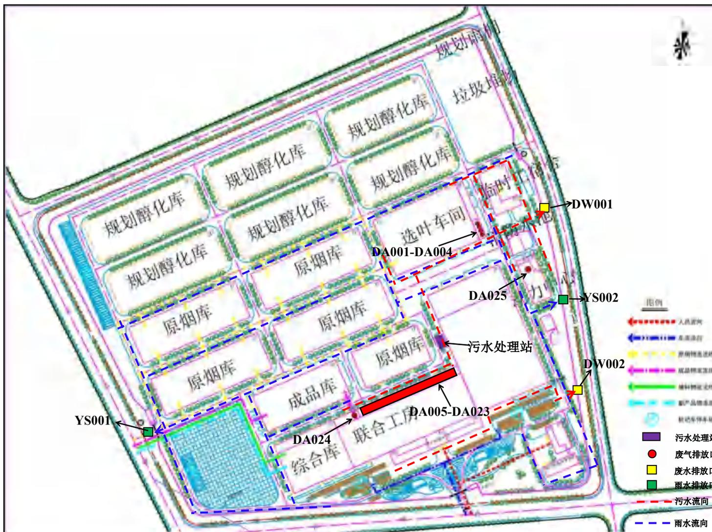
附图 4 项目平面布置及管网走向图
