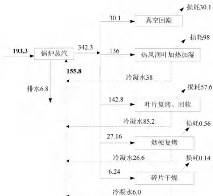
图 3.7-1 项目蒸汽平衡图 单位：m<sup>3</sup>/d
